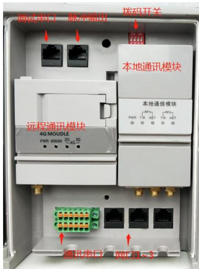
通信仓内包含远程通信模块、本地通信模块、以太网口 1~3、调试串口、脉冲串口，脉冲选择拨码开关、通信串口。
