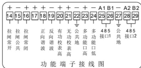
三相智能网关终端端子接线图
