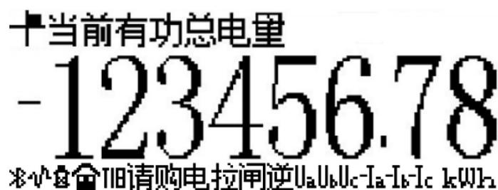
图 4 LCD 显示效果图
